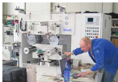
Bild 2: Messtechnische Ermittlung der Achsbewegung mit dem Laserinterferometer
